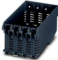
Tragschienengehäuse, Gehäuseunterteil mit Metallfußriegel, mit Lüftungsschlitzen, Breite: 75,87 mm, Höhe: 120,6 mm, Tiefe: 64,3 mm, Farbe: anthrazitgrau (ähnlich RAL 7016), Querverbindung: Tragschienen-Busverbinder (optional), Polzahl Querverbinder: 5 oder 8
