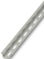
Tragschiene gelocht, nach EN 60715, Länge: 500 mm, Material: Stahl, verzinkt, dickschichtpassiviert, Montageart: Standardprofil, Farbe: silberfarben, Aktuelle Maßtoleranzen: Profiltoleranz durch Grat/scharfe Kanten =  $\pm 0,5$  mm, Anfangsmaß =  $\pm 0,5$  mm, Lochbild =  $\pm 0,5$  mm, Position der Löcher =  $\pm 0,5$  mm, Minimale Schienenlänge: Unperforiert:  $>20$  mm, Perforiert:  $>100$  mm, Letzte Stanzung bei Phoenix Contact:  $<1750$  mm
