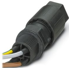
Wanddurchführung, Anschlussart: Einzeladern (angeschweißt)/ IDC-Anschluss, Polzahl: 3+PE, M25, Stift, 1 mm<sup>2</sup> ... 2,5 mm<sup>2</sup>, 690 V, 20 A, PA, schwarz, mit QUICKON-Mutter, Kodierung: kodiert, Leitungsaußendurchmesser: 9 mm ... 14 mm, 2,5 mm<sup>2</sup>, Adern glatt abgeschnitten, Leitungslänge: 0,5 m, mit zusätzlichem SEALING PLUG 14X22 RD
