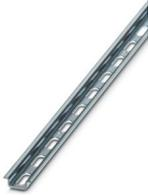
Tragschiene gelocht, Verpackungsvariante mit 10 Stück (20 m), nach EN 60715, Material: Stahl, verzinkt, weiß-passiviert, Standardprofil, Farbe: silberfarben
