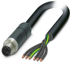
Powerleitung, 6-polig, PUR halogenfrei, schwarzgrau RAL 7021, Stecker gewinkelt M12, Kodierung: M, auf freies Leitungsende, Kabellänge: 15 m, für Wechselstrom bis 8 A/690 V
