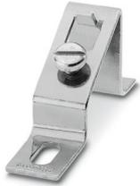
Schrägbügel mit Schraube M6, Anschlag zur Tragschiene, Befestigung der Tragschienen in einem Neigungswinkel von 30°, mit Schraube M6, Höhe: 35,4 mm
