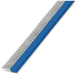
Band-Aderendhülsen, 2,5 mm<sup>2</sup>, Hüslenlänge 8 mm, mit Kunststoffkragen, nach DIN 46228-4, blau, zur Verarbeitung mit der CRIMPFOX 4 IN 1, 10 Streifen mit je 40 Hülsen pro Streifen.
