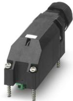
Anschlusshaube, Anwendung: Standard, Anschlussart: M8-Buchse Metall, Anzahl der Steckplätze: 8, Polzahl: 3, Steckplatzbelegung: einfach, Statusanzeige: nein, Universal; Stammleitungsanschluss: Steckbarer Schraubanschluss 180°, Schirmung: nein
