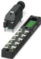
Verteilerbox, Anwendung: Standard, Anschlussart: M8-Buchse Metall, Anzahl der Steckplätze: 10, Polzahl: 3, Kodierung: A, Steckplatzbelegung: einfach, Statusanzeige: ja, PNP; Stammleitungsanschluss: steckbarer Push-in-Federanschluss 180°, Schirmung: nein
