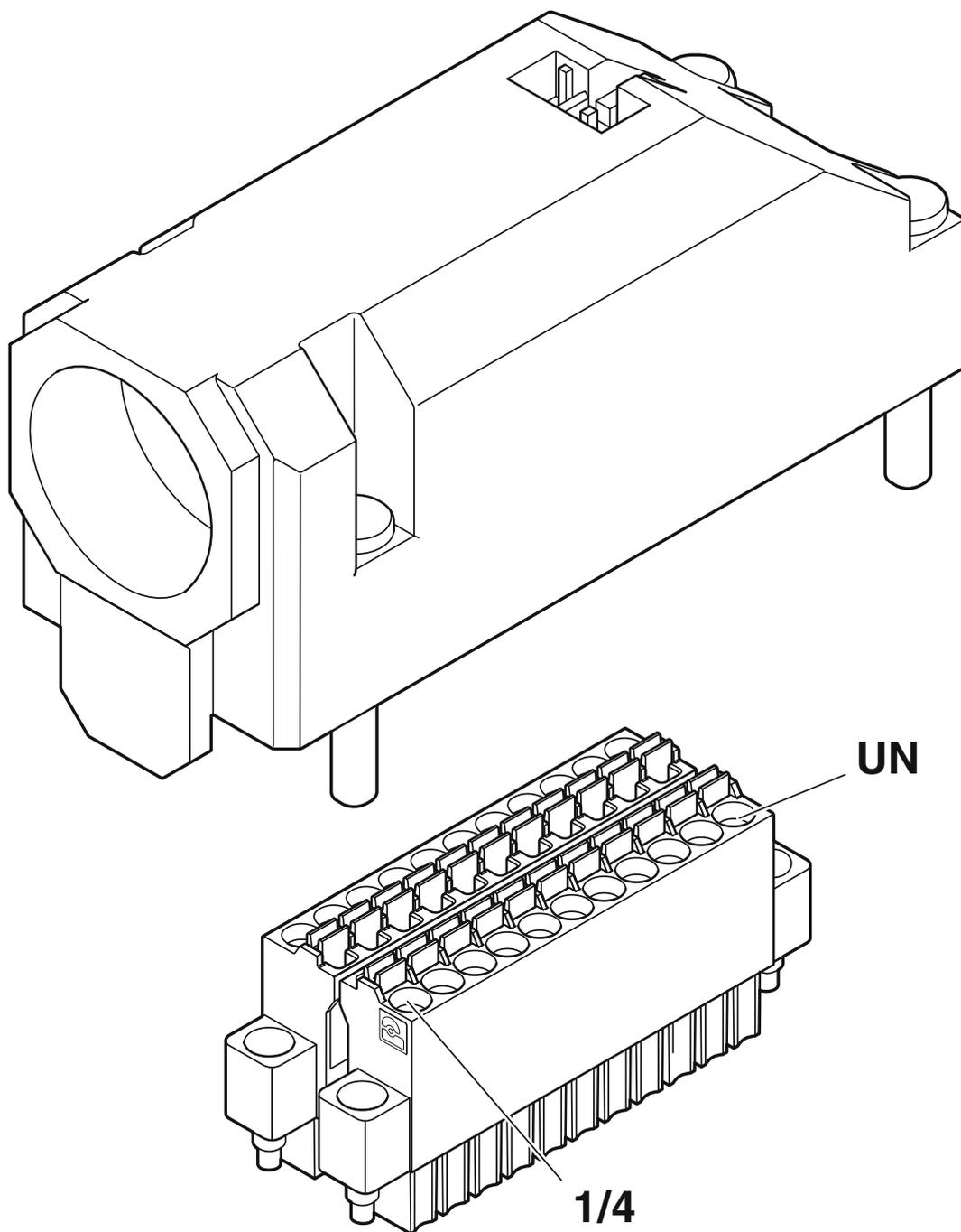
Positionierung der Leiterplattensteckverbinder - der Anschluss UN befindet sich an dem der Kabelverschraubung gegenüberliegenden Ende der Anschlusshaube
