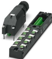
Verteilerbox, Anwendung: Standard, Anschlussart: M8-Buchse Metall, Anzahl der Steckplätze: 8, Polzahl: 3, Kodierung: A, Steckplatzbelegung: einfach, Statusanzeige: ja, PNP; Stammleitungsanschluss: Steckbarer Schraubanschluss 180°, Schirmung: nein
