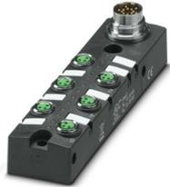
Verteilerbox, Anwendung: Standard, Anschlussart: M8-Buchse Metall, Anzahl der Steckplätze: 6, Polzahl: 3, Kodierung: A, Steckplatzbelegung: einfach, Statusanzeige: ja, PNP; Stammleitungsanschluss: M16-Steckanschluss 90°, Schirmung: nein
