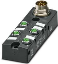
Verteilerbox, Anwendung: Standard, Anschlussart: M8-Buchse Metall, Anzahl der Steckplätze: 4, Polzahl: 3, Kodierung: A, Steckplatzbelegung: einfach, Statusanzeige: ja, PNP; Stammleitungsanschluss: M16-Steckanschluss 90°, Schirmung: nein
