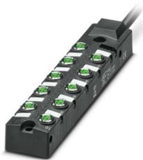
Verteilerbox, Anwendung: Standard, Anschlussart: M8-Buchse Metall, Anzahl der Steckplätze: 10, Polzahl: 3, Kodierung: A, Steckplatzbelegung: einfach, Statusanzeige: ja, PNP; Stammleitungsanschluss: Festanschluss 180°, PUR/PVC, Leitungslänge: 5 m, Schirmung: nein
