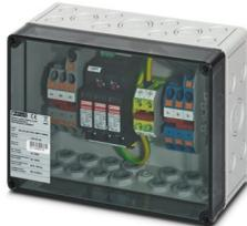
Generatoranschlusskasten für Photovoltaikanlagen bis 1000 V DC zum Anschluss von 1x 3 Strings. Gleiche Anzahl von Eingangs- und Ausgangsstrings. Mit Überspannungsschutz (Typ 1/2) und Kabelverschraubungen für die Eingangs- und Ausgangsseite.
