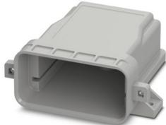
Belüftetes Gehäuse der ECS-Familie, Schraubverriegelung, Schutzart: IP66/IP67/IP68/IP69 bei Kombination mit zugehöriger Frontplatte, Farbe: grau (7042), Breite: 97 mm, Höhe: 86 mm, Tiefe: 45 mm
