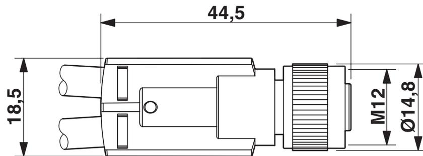
Buchse M12 x 1, Y-Verteiler
