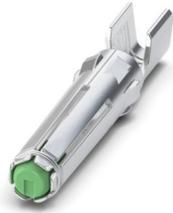
Crimpkontakt, Serie: SUNCLIX, Buchse, gerollt, Bemessungsstrom: 27 A, Anschlussquerschnitt: 2,5 mm<sup>2</sup> ... 4 mm<sup>2</sup>, AWG 14...12, Material Kontakt: Cu
