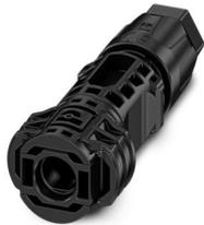
Photovoltaik-Steckverbinder, Artikelfamilie: SUNCLIX, Farbe: schwarz, Polzahl: 1, Aderquerschnitt min.: 2,5 mm<sup>2</sup>, Aderquerschnitt max.: 6 mm<sup>2</sup>, Bemessungsspannung: 1500 V DC, Bemessungsstrom: 38 A, Anschlussart: Crimp, Kabeldurchmesser min.: 5 mm, Kabeldurchmesser max.: 8 mm
