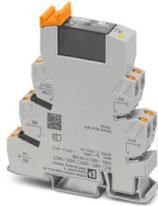
PLC-INTERFACE für Ausgabefunktionen, bestehend aus Grundklemme PLC-BSC.../ACT mit Push-in-Anschluss und steckbarem Miniatur-Solid-State-Relais, zur Montage auf Tragschiene NS 35/7,5, 1 Schließer, Eingang: 24 V DC, Ausgang: 3 ... 33 V DC/5 A
