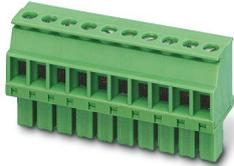
Leiterplattenstecker, Nennquerschnitt: 1,5 mm<sup>2</sup>, Farbe: grün, Nennstrom: 8 A, Bemessungsspannung (III/2): 160 V, Kontaktoberfläche: Sn, Kontaktart: Buchse, Anzahl der Reihen: 1, Polzahl: 6, Artikelfamilie: MCVW 1,5/..-ST, Rastermaß: 3,5 mm, Anschlussart: Schraubanschluss mit Zughülse, Schraubenangriffsform: L Längsschlitz, Anschlussrichtung Leiter/Platine: -90 °, Stecksystem: COMBICON MC 1,5, Verriegelung: ohne, Befestigungsart: ohne, Verpackungsart: verpackt im Karton
