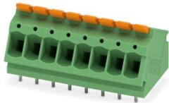
Leiterplattenklemme, Nennstrom: 24 A, Bemessungsspannung (III/2): 400 V, Nennquerschnitt: 2,5 mm<sup>2</sup>, Anzahl der Potenziale: 8, Anzahl der Reihen: 1, Polzahl pro Reihe: 8, Artikelfamilie: LPTA 2,5/, Rastermaß: 5 mm, Anschlussart: Hebel-Push-in-Anschluss, Montage: Wellenlöten, Anschlussrichtung Leiter/Platine: 30 °, Farbe: grün, Pin-Layout: Lineares Pinning, Pinlänge [P]: 3,5 mm, Verpackungsart: verpackt im Karton
