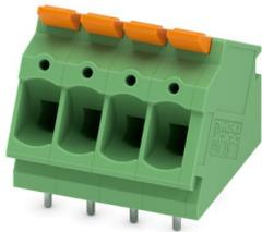
Leiterplattenklemme, Nennstrom: 24 A, Bemessungsspannung (III/2): 400 V, Nennquerschnitt: 2,5 mm<sup>2</sup>, Anzahl der Potenziale: 4, Anzahl der Reihen: 1, Polzahl pro Reihe: 4, Artikelfamilie: LPTA 2,5/, Rastermaß: 5 mm, Anschlussart: Hebel-Push-in-Anschluss, Montage: Wellenlöten, Anschlussrichtung Leiter/Platine: 30 °, Farbe: grün, Pin-Layout: Lineares Pinning, Pinlänge [P]: 3,5 mm, Verpackungsart: verpackt im Karton
