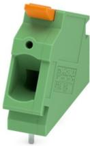
Leiterplattenklemme, Nennstrom: 24 A, Bemessungsspannung (III/2): 400 V, Nennquerschnitt: 2,5 mm<sup>2</sup>, Anzahl der Potenziale: 1, Anzahl der Reihen: 1, Polzahl pro Reihe: 1, Artikelfamilie: LPTA 2,5/, Rastermaß: 5 mm, Anschlussart: Hebel-Push-in-Anschluss, Montage: Wellenlöten, Anschlussrichtung Leiter/Platine: 30 °, Farbe: grün, Pin-Layout: Lineares Pinning, Pinlänge [P]: 3,5 mm, Verpackungsart: verpackt im Karton
