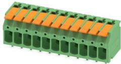
Leiterplattenklemme, Nennstrom: 24 A, Bemessungsspannung (III/2): 400 V, Nennquerschnitt: 2,5 mm<sup>2</sup>, Anzahl der Potenziale: 11, Anzahl der Reihen: 1, Polzahl pro Reihe: 11, Artikelfamilie: LPT 2,5/, Rastermaß: 5 mm, Anschlussart: Hebel-Push-in-Anschluss, Montage: Wellenlöten, Anschlussrichtung Leiter/Platine: 0 °, Farbe: grün, Pin-Layout: Lineares Pinning, Pinlänge [P]: 3,5 mm, Verpackungsart: verpackt im Karton
