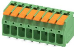
Leiterplattenklemme, Nennstrom: 24 A, Bemessungsspannung (III/2): 400 V, Nennquerschnitt: 2,5 mm<sup>2</sup>, Anzahl der Potenziale: 8, Anzahl der Reihen: 1, Polzahl pro Reihe: 8, Artikelfamilie: LPT 2,5/, Rastermaß: 5 mm, Anschlussart: Hebel-Push-in-Anschluss, Montage: Wellenlöten, Anschlussrichtung Leiter/Platine: 0 °, Farbe: grün, Pin-Layout: Lineares Pinning, Pinlänge [P]: 3,5 mm, Verpackungsart: verpackt im Karton
