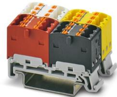
Funktionsverteilerblock, für KNX-Bus in der Gebäudeinstallation, einzelner Block ist intern gebrückt, Farbe nach EIB-Kabelcodierung, Anordnung: Paarweise, Nennspannung: 500 V, Nennstrom: 17,5 A, Anzahl der Anschlüsse: 24, Anschlussart: Push-in-Anschluss, Querschnitt: 0,14 mm<sup>2</sup> - 2,5 mm<sup>2</sup>, Montageart: NS 35/7,5, NS 35/15
