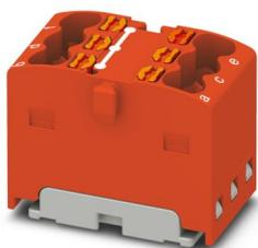
Verteilerblock, intern gebrückt, Nennspannung: 450 V, Nennstrom: 17,5 A, Anzahl der Anschlüsse: 6, Anschlussart: Push-in-Anschluss, Querschnitt: 0,14 mm<sup>2</sup> - 2,5 mm<sup>2</sup>, Montageart: aufrasten auf Tragschienenadapter, Direktmontage mit Flansch, Fliegend, Farbe: rot
