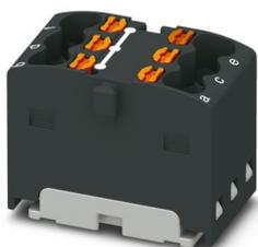
Verteilerblock, intern gebrückt, Nennspannung: 450 V, Nennstrom: 17,5 A, Anzahl der Anschlüsse: 6, Anschlussart: Push-in-Anschluss, Querschnitt: 0,14 mm<sup>2</sup> - 2,5 mm<sup>2</sup>, Montageart: aufrasten auf Tragschienenadapter, Direktmontage mit Flansch, Fliegend, Farbe: schwarz
