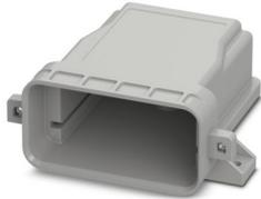
Nicht belüftetes Gehäuse der ECS-Familie, Schraubverriegelung, Schutzart: IP66/IP67/IP68/IP69 bei Kombination mit zugehöriger Frontplatte, Farbe: grau (7042), Breite: 97 mm, Höhe: 86 mm, Tiefe: 44 mm
