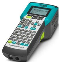
Mobiler Thermotransferdrucker für Markierungsmaterialien im Kassettenformat. Der Drucker kann Materialien im Endlosformat bis zu einer Materialbreite von 24 mm bedrucken.
