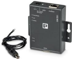
Serieller Geräte-Server zur Konvertierung serieller Daten (RS-232/422/485) in Ethernet-Daten (RJ45). Unterstützt TCP- und UDP-Protokolle in Ergänzung zu Modbus/RTU (oder ASCII) und Modbus/TCP. COM-Port-Redirector-Software steht als Download zur Verfügung. Umfasst einen RJ45-Anschluss und einen D-SUB-9-Anschluss.
