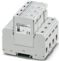
CHARX protect advanced, steckbarer Blitzstrom- / Überspannungsableiter, gem. Typ 1/2 / Class I/II, für 3-phasige Stromversorgungsnetze mit separatem N und PE (5-Leiter-System: L1, L2, L3, N, PE). Speziell für den Einsatz in der Elektromobilität geeignet.
