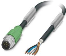
Sensor-/Aktor-Kabel, 5-polig, PUR halogenfrei, schwarzgrau RAL 7021, geschirmt, Stecker gerade M12, Kodierung: A, auf freies Leitungsende, Kabellänge: 60 m
