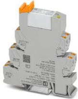
PLC-INTERFACE für Ausgabefunktionen, bestehend aus Grundklemme PLC-BPT.../ACT mit Push-in-Anschluss und steckbarem Miniaturrelais mit Leistungskontakt, zur Montage auf Tragschiene NS 35/7,5, 2 Schließer (1-1), Eingangsspannung 24 V DC
