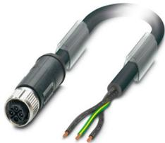
Powerleitung, 3-polig, PUR halogenfrei, schwarz, freies Leitungsende, auf Buchse gerade M12, Kodierung: S, Kabellänge: 2 m, für Wechselstrom bis 16 A/690 V
