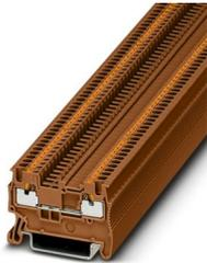
Durchgangsklemme, Nennspannung: 500 V, Nennstrom: 17,5 A, Anzahl der Anschlüsse: 2, Anschlussart: Push-in-Anschluss, Bemessungsquerschnitt: 1,5 mm<sup>2</sup>, 1. Etage, Querschnitt: 0,14 mm<sup>2</sup> - 1,5 mm<sup>2</sup>, Montageart: NS 35/7,5, NS 35/15, Farbe: braun
