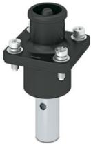
Steckverbinder, Artikelfamilie: BPC, Farbe: schwarz, Polzahl: 1, Aderquerschnitt min.: 35 mm<sup>2</sup>, Aderquerschnitt max.: 35 mm<sup>2</sup>, Bemessungsspannung: 1500, Bemessungsstrom: 160 A, Anschlussart: Crimp
