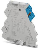
Ex i-Ventilsteuerbaustein zur Ansteuerung von Ex i-Magnetventilen im Ex-Bereich. Leerlaufspannung: 20 V DC, Strombegrenzung: 25 mA, Standardkonfiguration, Leitungsfehlererkennung, Safety Integrity Level (SIL, IEC 61508): 3, Schraubanschluss
