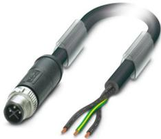
Powerleitung, 3-polig, PUR halogenfrei, schwarz, Stecker gerade M12, Kodierung: S, auf freies Leitungsende, Kabellänge: 1 m, für Wechselstrom bis 16 A/690 V
