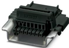
Tragschienen-Busverbinder, Farbe: schwarz, Nennstrom: 6 A, 4 A (parallele Kontakte) (serielle Kontakte), Bemessungsspannung (III/2): 32 V, Polzahl: 8, Artikelfamilie: TBUS8-25..., Rastermaß: 2,54 mm, Montage: Tragschienenmontage, Verriegelung: ohne, Befestigungsart: ohne, Verpackungsart: verpackt im Karton, Artikel mit vergoldeten Kontakten, Busstecker zur Verbindung mit Elektronikgehäusen, 4 Parallelkontakte/4 serielle Kontakte
