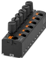
Funktionsverteilerblock, Sicherungstyp: G / 5 x 20, Nennspannung: 250 V, Nennstrom: 6,3 A, Anschlussart: Push-in-Anschluss, Abgriff, Bemessungsquerschnitt: 4 mm<sup>2</sup>, Querschnitt: 0,2 mm<sup>2</sup>- 6 mm<sup>2</sup>, Anschlussart: Push-in-Anschluss, Sammelanschluss, Bemessungsquerschnitt: 16 mm<sup>2</sup>, Querschnitt: 0,5 mm<sup>2</sup>- 16 mm<sup>2</sup>, Montageart: aufrasten auf Tragschienenadapter, Direktmontage mit Flansch, Fliegend, Farbe: schwarz
