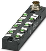
Verteilerbox, Anwendung: Standard, Anschlussart: M8-Buchse Metall, Anzahl der Steckplätze: 8, Polzahl: 3, Kodierung: A, Steckplatzbelegung: einfach, Statusanzeige: ja, PNP; Stammleitungsanschluss: M16-Steckanschluss 90°, Schirmung: nein
