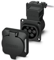
CHARX connect modular, Typ 2, Infrastruktur-Ladedose, 32 A , 480 V AC, Premium, Set, ohne Einzeladern, Verriegelungsaktuator: 12 V, 3-polig, eckig, Rückwandmontage, M5-Gewinde, Gehäuse: schwarz, mit eckigem Schutzdeckel, mit Temperatursensoren, mit LED (gemeinsamer Kathodenanschluss), zum Laden mit Wechselstrom (AC) von Elektrofahrzeugen (EV), PHOENIX CONTACT-Logo, IEC 62196-2
