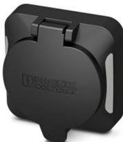
CHARX connect modular, Typ 2, Schutzdeckel, Zubehör, Premium, eckig, Vorderwandmontage, M5-Gewinde, mit selbstschließendem Mechanismus, mit LED (gemeinsamer Kathodenanschluss), zur Anbringung an Infrastruktur-Ladesteckdosen, Eingepprägtes PHOENIX CONTACT-Logo, IEC 62196-2
