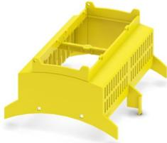
Tragschienengehäuse für den Einsatz in Installationsverteilern nach DIN 43880, Gehäuseoberteil (U11) mit Lüftungsschlitzen, Einbautiefe Anschluss technik: 11,1 mm, Breite: 107,6 mm, Höhe: 89,7 mm, Tiefe: 54,85 mm, Farbe: gelb (ähnlich RAL 1018)
