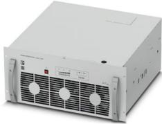
CHARX power basic, Schnelllademodul für den Aufbau von DC-Ladestationen, Rack-Montage, Eingang: 3-phasig, Ausgang: 200 V DC...920 V DC / 125 A. Der Betrieb des DC-Leitungsmoduls erfordert den zugehörigen Systemschaltschrank CHARX PS-CAB/4x87.5KW (Art.-Nr. 1165442)
