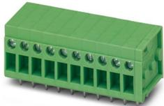
Leiterplattenklemme, Nennstrom: 24 A, Bemessungsspannung (III/2): 400 V, Nennquerschnitt: 2,5 mm<sup>2</sup>, Anzahl der Reihen: 1, Polzahl pro Reihe: 3, Artikelfamilie: FRONT 2,5-H/SA10, Rastermaß: 5 mm, Anschlussart: Frontschraubanschluss, Montage: Wellenlöten, Anschlussrichtung Leiter/Platine: 0 °, Farbe: grün, Pin-Layout: Lineares Pinning, Pinlänge [P]: 5 mm, Anzahl der Lötpins pro Potenzial: 2, Verpackungsart: verpackt im Karton
