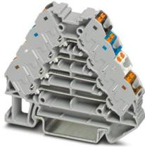
Rangierverteiler, Nennspannung: 250 V, Nennstrom: 10 A, Anschlussart: Push-in-Anschluss, 1., 2., 3. und 4. Etage, Bemessungsquerschnitt: 1,5 mm<sup>2</sup>, Querschnitt: 0,14 mm<sup>2</sup> - 2,5 mm<sup>2</sup>, Montage: NS 35/7,5, NS 35/15, Farbe: grau, Farbe Anschlusselemente: mehrfarbig
