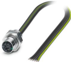
Gerätesteckverbinder Hinterwand, Leistung, 6-polig, Buchse, gerade, M12, M-Kodierung, auf freies Leitungsende, Einzellitzen, Kabellänge: 1,5 m, 1,31 mm<sup>2</sup>, UL/cUL Schaltlitze, vergossen, dieser Artikel ist voraussichtlich ab 2027-Q1 nach RoHS II ohne Ausnahme 6c (Pb < 0,1 %) bleifrei, auf Anfrage ist eine bleifreie Alternative vorab möglich
