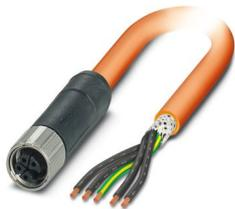
Powerleitung, 5-polig, PUR halogenfrei, orange RAL 2003, geschirmt (Advanced Shielding Technology), freies Leitungsende, auf Buchse gerade M12, Kodierung: K, Kabellänge: 20 m, für Wechselstrom bis 16 A/690 V
