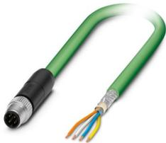
Netzwirkabel, PROFINET CAT5 (100 MBit/s), EtherCAT® CAT5 (100 MBit/s), 4-polig, PVC/PVC, grün RAL 6018, geschirmt (Advanced Shielding Technology), Stecker gerade M8, Kodierung: D / IP67, auf freies Leitungsende, Kabellänge: 2 m
