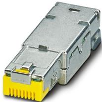
RJ45-Stifteinsatz, Bauform: RJ45, Schutzart: IP20, Polzahl: 8, 10 GBit/s, CAT6<sub>A</sub> (IEC 60512-27-100:2008, TIA-568-C.2:2009), Material: Metall, Anschlussart: Schneidklemmanschluss, Anschlussquerschnitt: AWG 26- 24, Kabelabgang: gerade, Ethernet
