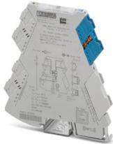
Ex i-NAMUR-Trennschaltverstärker zum Betrieb von Näherungsinitiatoren und Schaltern. Die Signale werden über 1 Solid-State-Relais am Ausgang (passiv) zur Steuerungsebene übertragen. Anzahl der Kanäle: 1, Standardkonfiguration, Leitungsfehlererkennung, Safety Integrity Level (SIL, IEC 61508): 3, Push-in-Anschluss
